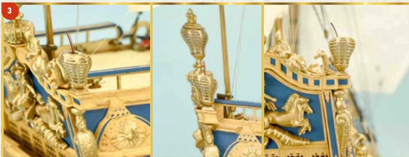
**3** Установите этот фонарь на правом углу гакаборта. Если вы устанавливаете систему освещения, проведите провода внутрь фонаря.
